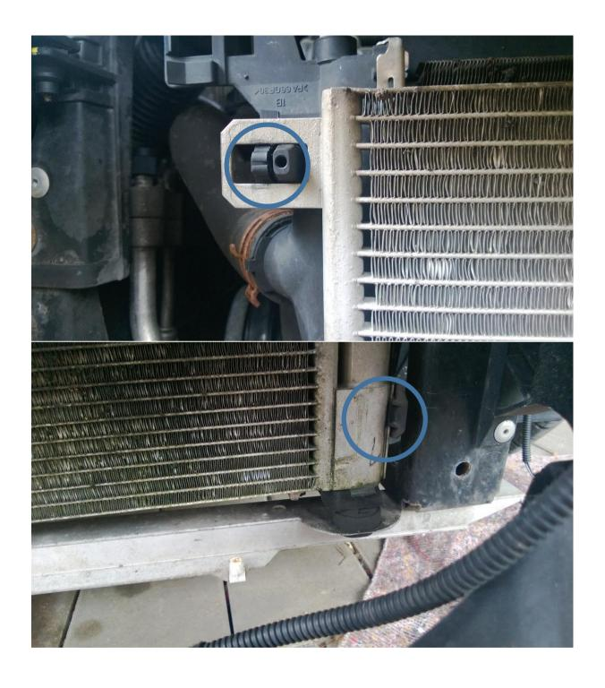
Nachdem alle Verbindungen getrennt sind, den Kondensator nach oben herausheben
