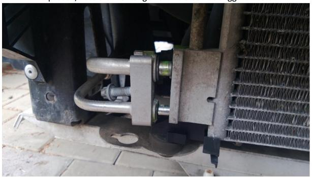
Jetzt muss der Kondensator nur noch ausgeklippst werden
