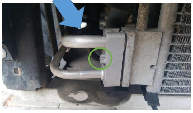
Aufpassen, dass die Dichtungen dranbleiben oder ggf. ersetzen
